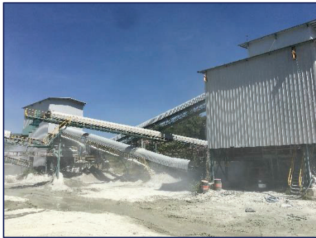
รูปที่ 2-25: การปิดคลุมสายพานลำเลียงแร่
